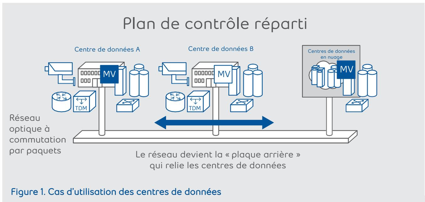
La technologie de longueur d'onde peut servir de plaque arrière entre les centres de données, assurant la transmission haute vitesse et à faible temps d'attente des données et des applications ainsi que l'interconnexion des serveurs et des ressources de stockage et permettant une surveillance améliorée du service.
