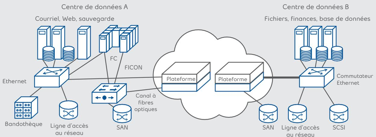
Figure 2. Interconnexion d'applications de stockage entre des centres de données distants
